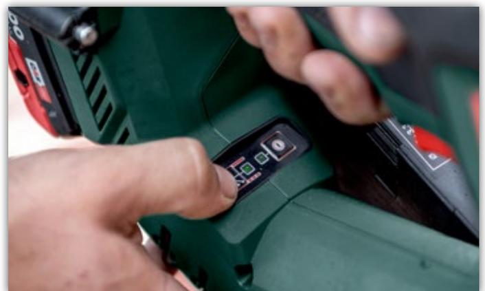
Der NFR 18 LTX 90 BL verfügt über zwei Funktionen: Zwischen Einzelschuss-Modus und Kontaktauslösung kann flexibel durch Knopfdruck gewechselt werden.
