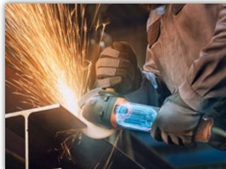
Der voll geschlossene bürstenlose Motor und eine staubgeschützte, separat verbaute Motor-Elektronik machen die CG-15-Baureihe im Vergleich zu Produkten mit Universalmotoren zu echten Dauerläufern.
