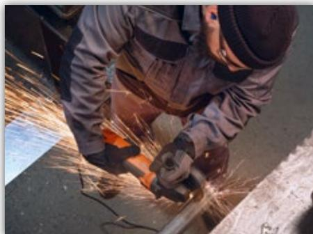
Dank wirksamer Bremse, Sanftanlauf, Wiederanlaufschutz, Rückschlagkontrolle und Blockierüberwachung wird die Arbeitssicherheit deutlich erhöht.
