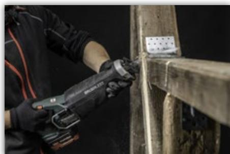
Die leistungsstarke Akku-Säbelsäge SSEP 18 LTX BL MVT von Metabo sägt auch gemischte Materialien effizient und ist so ideal für harte Abbrucharbeiten. Der zuschaltbare Pendelhub sorgt für einen besonders schnellen Sägefortschritt auch bei schwersten Einsätzen.
