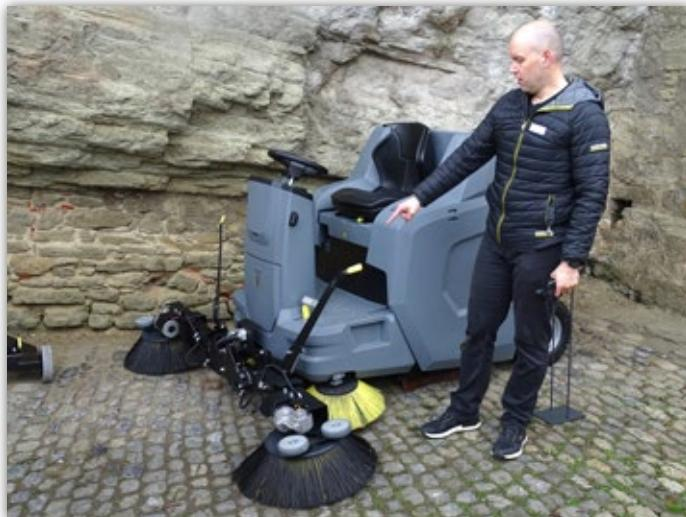
Auf Wunsch der Schweiz in Winnenden entwickelt: Kehrmaschine zur Reinigung von Bahnperrons. Die Außenbesen sind auf einem Wagen demontierbar.
