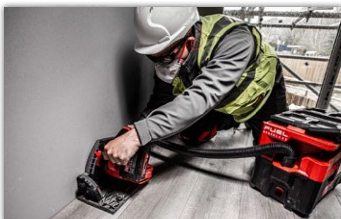
Die flache Schutzhülle ermöglicht wandbündige Schnitte mit nur 12 mm Distanz zur Wand.
