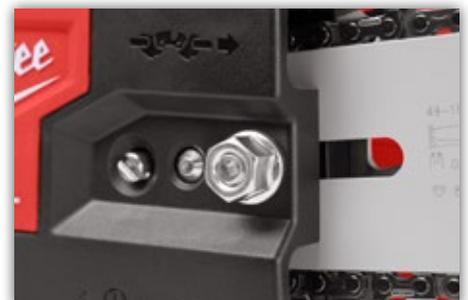
Besonders anwenderfreundlich ist der leicht zugängliche Kettenspanner, der eine schnelle Anpassung der Kettenspannung ermöglicht.
