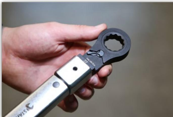
Les nouveaux inserts de forme plate, offrent des avantages lors des travaux dans des espaces de construction étroits, en raison de leur fonctionnalité équivalente à celle d'une clé polygonale à cliquet.
