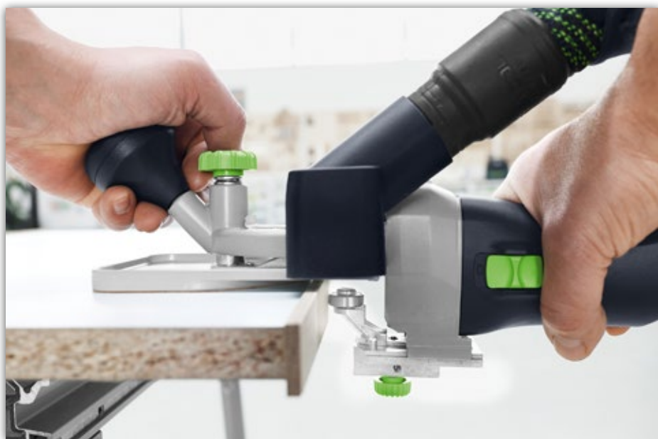
Zur «MFKC 700 EB-Basic» von Festool gibt es ein Zubehörset für das Bündigfräsen von Massivholzkanten.
